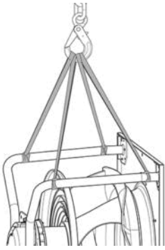
Abb. 1: Hebeskizze für den Transport des RadiPac
