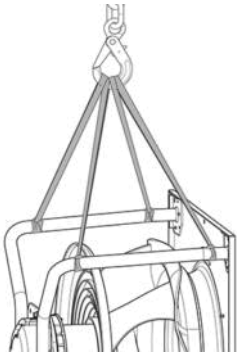
Abb. 1: Hebeskizze für den Transport des RadiPac
