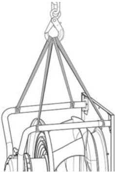
Abb. 1: Hebeskizze für den Transport des RadiPac
