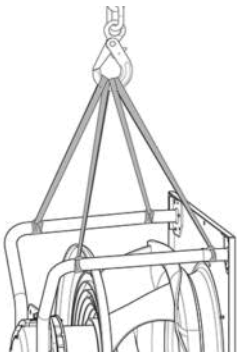
Abb. 1: Hebeskizze für den Transport des RadiPac
