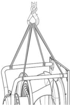
Abb. 1: Hebeskizze für den Transport des RadiPac
