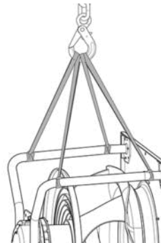
Abb. 1: Hebeskizze für den Transport des RadiPac
