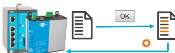
Abbildung 9: Profil-Handling – Aktivieren von Konfigurationsänderungen
