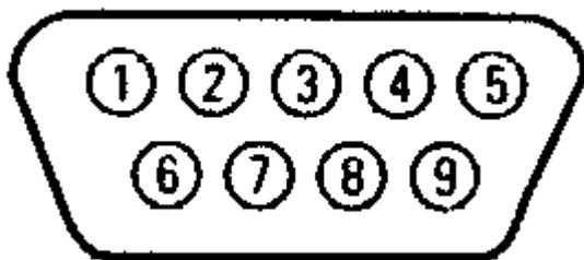
Abbildung 6: ECR – Anschluss RS232-Schnittstelle
