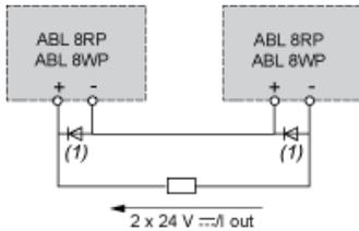
(1) 2 Schottky-Dioden I<sub>min</sub> = In der Spannungsversorgung und V<sub>min</sub> = 50 V.
