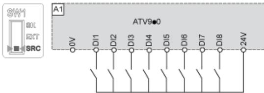
Schalter in Stellung „SRC (Quelle)“ und Verwendung einer externen Versorgung für die Digitaleingänge
