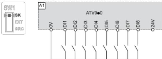
Schalter in Stellung „EXT“ bei Verwendung einer externen Versorgung für die Digitaleingänge
