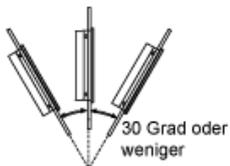
Bei Montage dieses Produkts in schräger Position mit einer Neigung von mehr als 30° darf die Umgebungstemperatur nicht höher sein als 40 °C (104 °F). Gegebenenfalls müssen Sie eine Gebläseluftkühlung (Ventilator, Klimaanlage) einsetzen, damit eine Umgebungsbetriebstemperatur von höchstens 40 °C (104 °F) gewährleistet ist.
