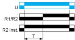
2 zeitverzögerte Ausgänge (R1/R2) oder 1 zeitverzögerter Ausgang (R1) und 1 unverzögerter Ausgang (R2 inst.)
