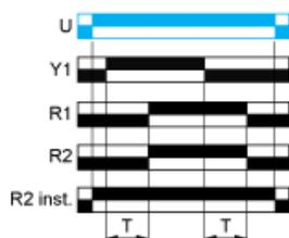
Funktion Ad: Impulsverzögerungsrelais mit Steuersignal
