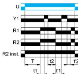
$$T = t_1 + t_2 + \dots$$
