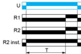
Funktion At: Einschaltverzögerungsrelais mit Pausen- / Summationssteuersignal
