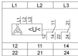
L1,L2,L3: Zu überwachende Spannung
