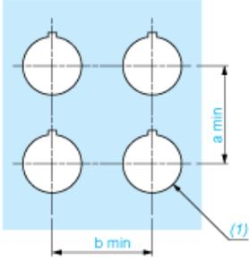
(1) Durchmesser auf fertiger Schalttafel oder Montagehalterung
