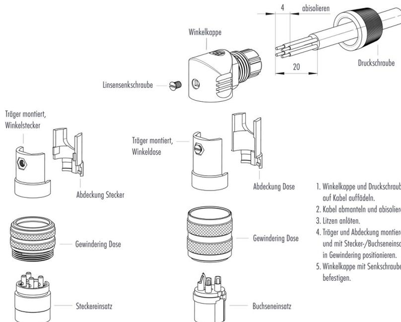
1. Winkelkappe und Druckschraube auf Kabel auffädeln.
