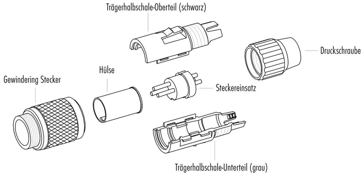
**Achtung:** max. Drehmoment des Gewindinges im Flanschsteckverbinder: 50cNm (handfest)
