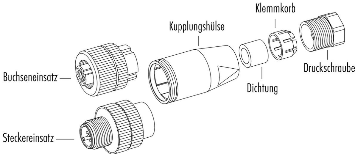
Material der Gewinderinge: Zink Druckguss, Edelstahl
