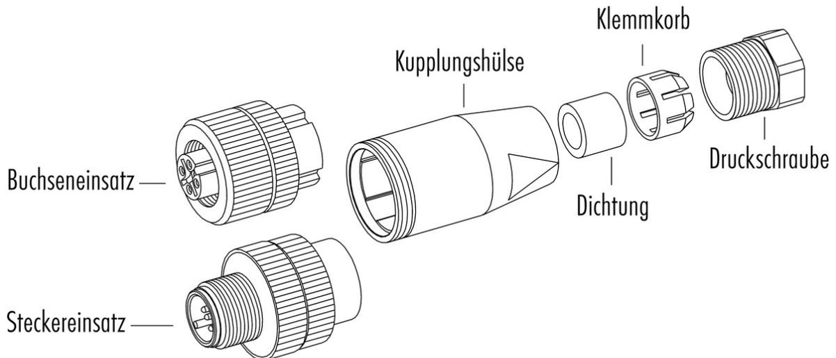
Material der Gewinderinge: Zink Druckguss, Edelstahl
