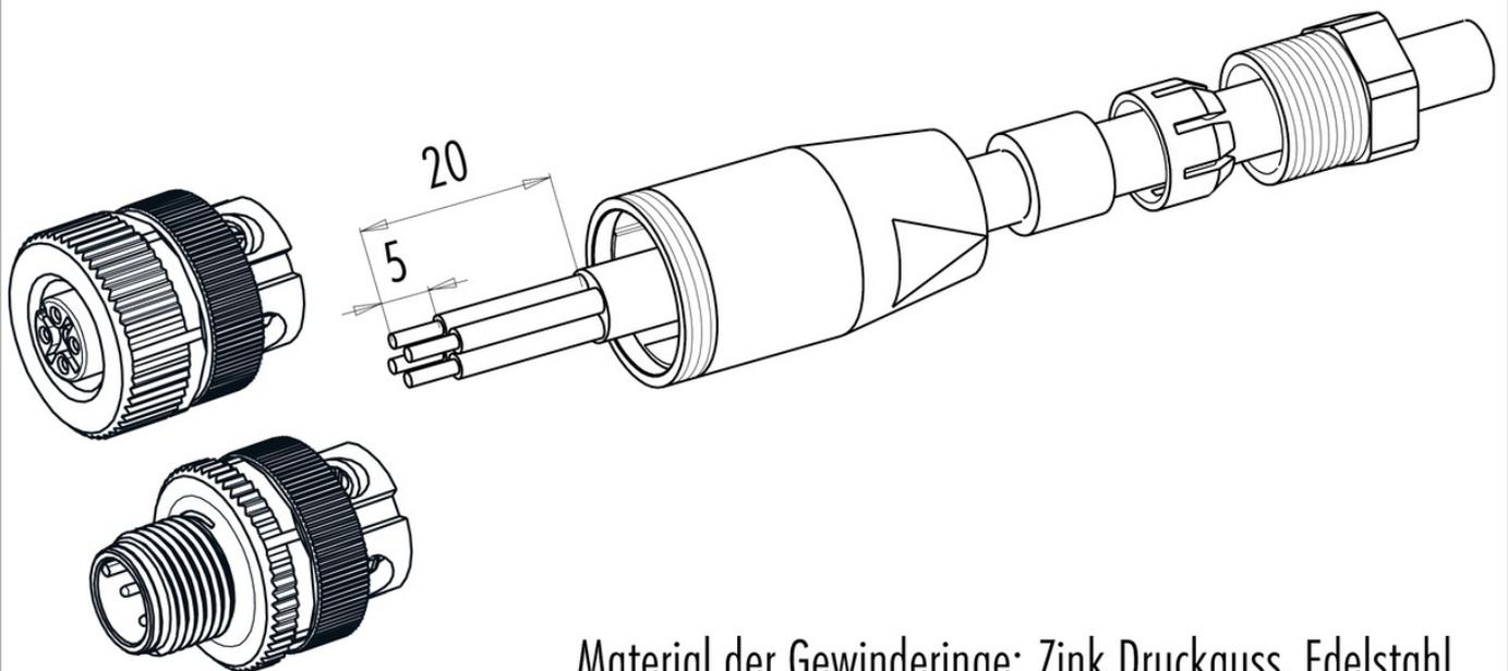
Material der Gewinderinge: Zink Druckguss, Edelstahl
