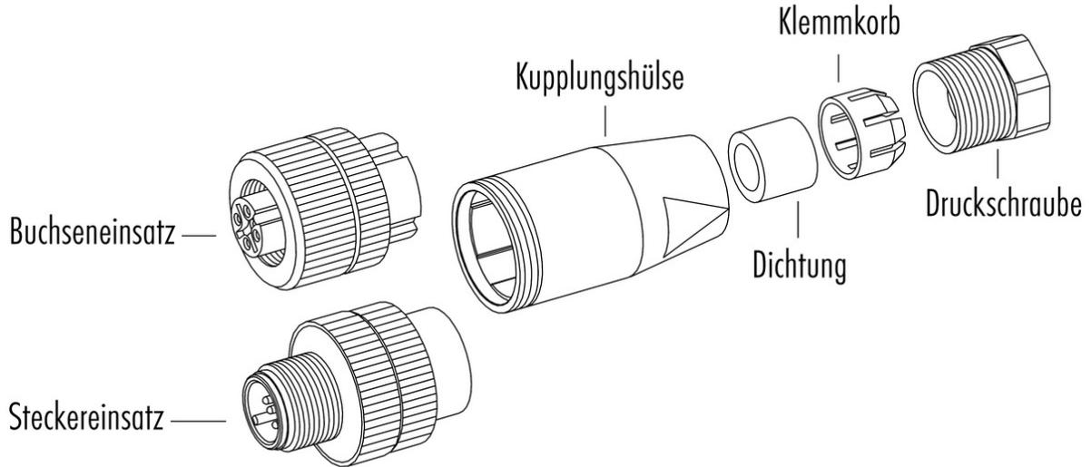
Material der Gewinderinge: Kunststoff, Zink Druckguss, Edelstahl
