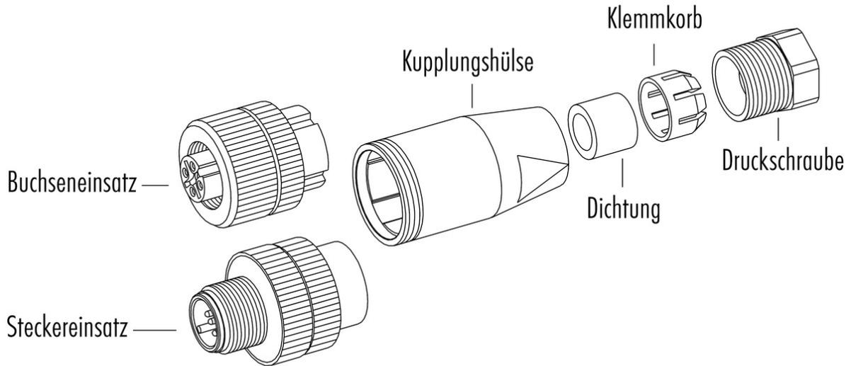
Material der Gewinderinge: Kunststoff, Zink Druckguss, Edelstahl
