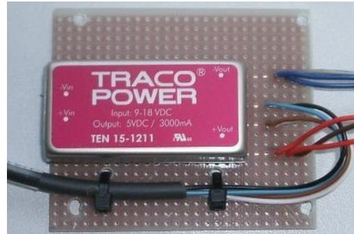
Abbildung 19; DC/DC Platine
