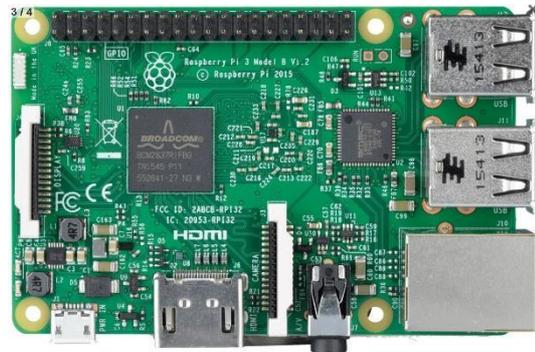
Abbildung 18; Raspberry Pi 3 Model B
